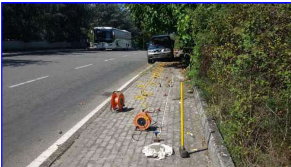
Fig. 3 – Sorgente energizzante, costituita da massa battente su piastra di alluminio. Come starter/trigger è stato utilizzato un geofono verticale Geospace a 14Hz.
